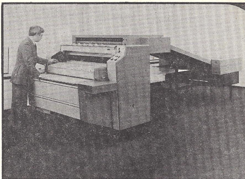
De Océ 281 voor het automatisch lichtdrukken, op maat snijden en vouwen van tekeningen (met een snelheid van 15 m per minuut).
